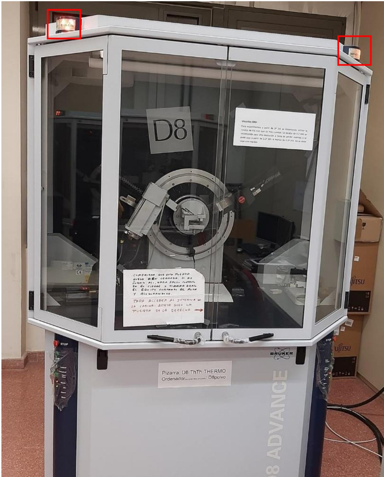
Figura 1. Difractómetro D8TT. Indicadores de alta tensión encendidos (enmarcados en rojo).
