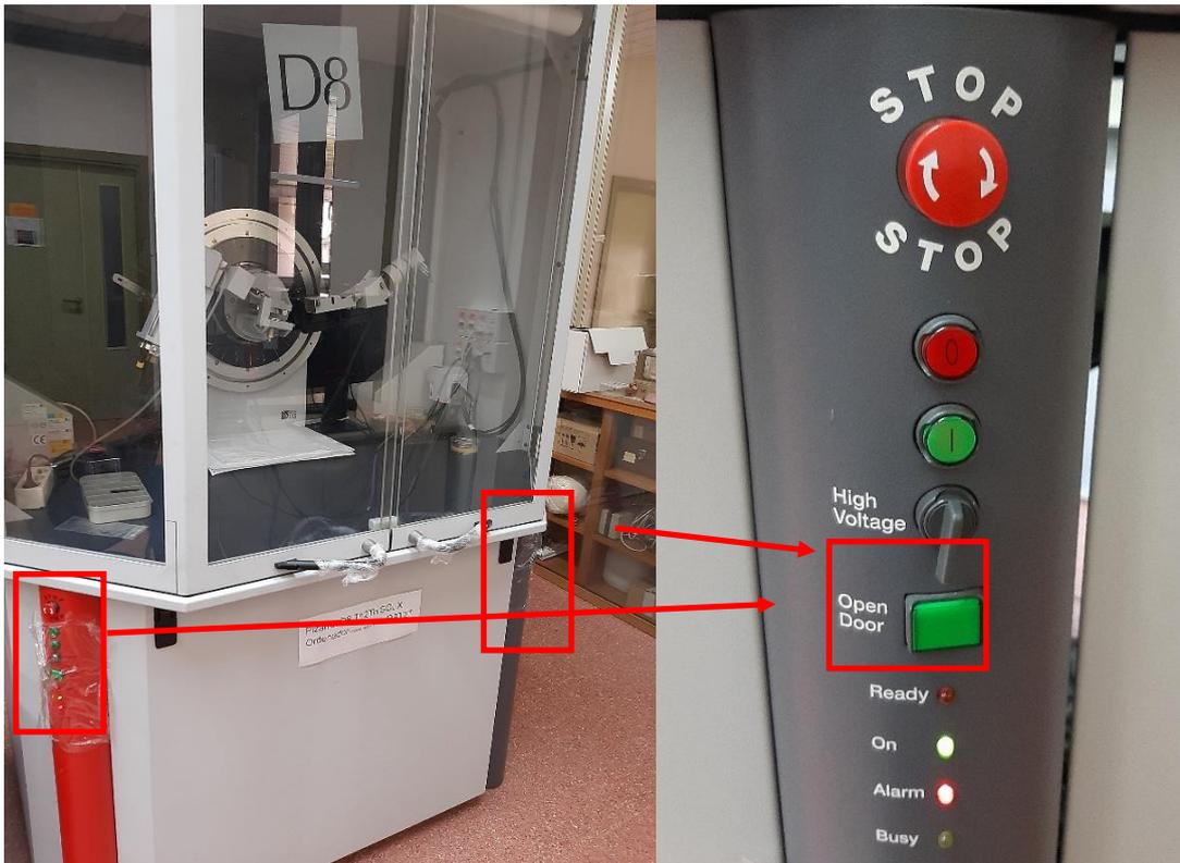
Figura 4. Panel de control de la cabina de trabajo del D8T2T (enmarcados en rojo).
