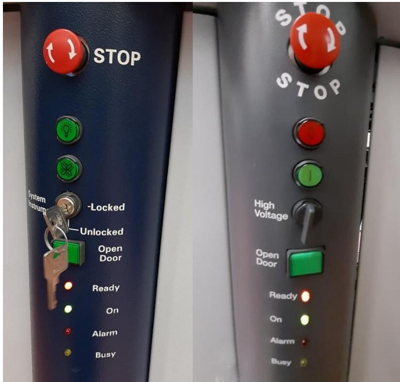
Figura 3. Paneles de control izquierdo y derecho de la cabina de trabajo del D8T2T solx.
