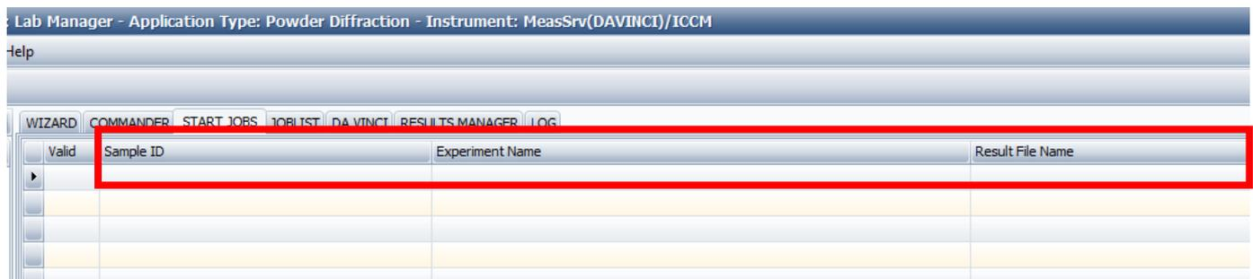
Figura 19. Pantalla del software DIFFRAC.MEASUREMENT al seleccionar la pestaña Start Job para el lanzamiento de la medida.
