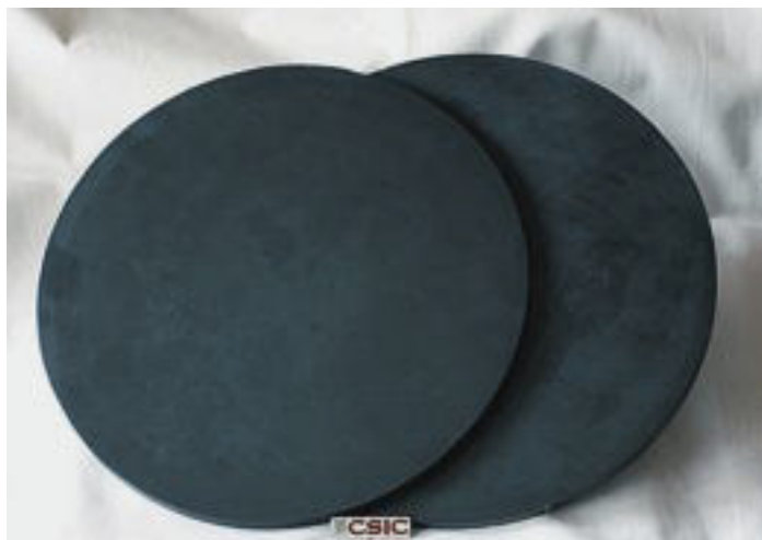
Discos de materiales ultraestables sinterizados por SPS
